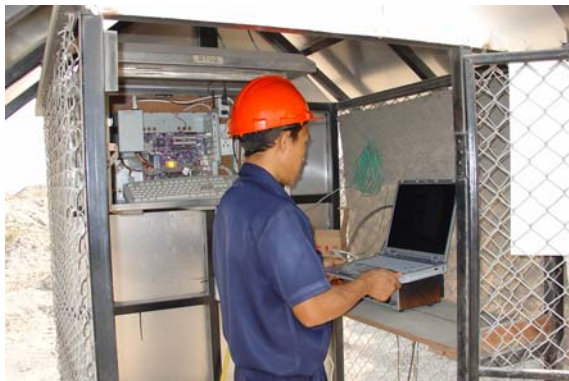
การตรวจวัดข้อมูลการเคลื่อนตัวของผนัง บ่อเหมือง จากสถานีเก็บและวิเคราะห์ ข้อมูลในสนาม
