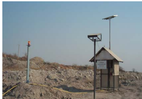
ระบบแจ้งเตือนการพังทลายด้วยสัญญาณ แสงและเสียง
