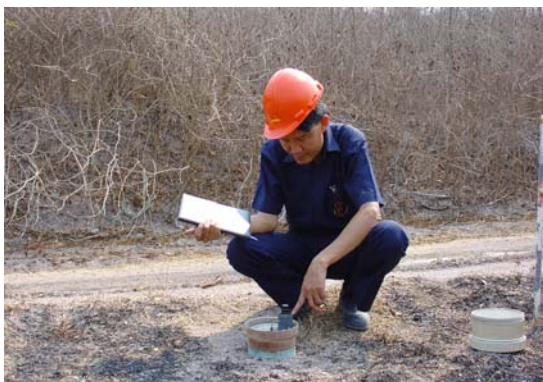
การตรวจวัดข้อมูลการเคลื่อนตัวได้ดิน ของผนังบ่อเหมืองแม่เมาะด้วยเครื่องมือ Shear Monitor
