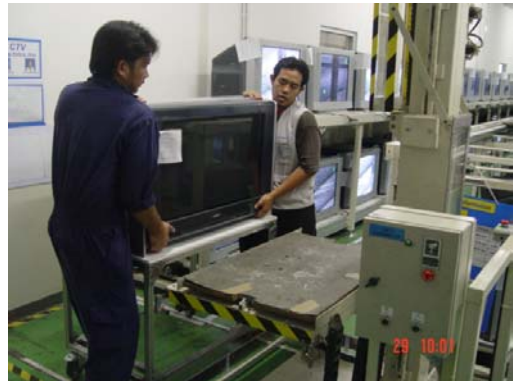
นำโทรทัศน์ขึ้นแท่นยกโดยปรับ แท่นยกให้อยู่ระดับเดียวกับรถเข็น
