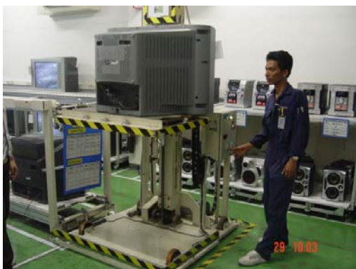
กดปุ่มปรับแท่นยกให้อยู่ในระดับ ความสูงเดียวกับชั้นวางที่ต้องการ
