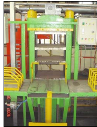
แทนเครื่องอัดพื้นขนาด 125 ตัน ใช้ความร้อนจาก ไอน้ำที่อุณหภูมิ 150 เซลเซียส ใส่แม่พิมพ์ได้ 3-4 แม่พิมพ์ยกแม่พิมพ์ด้วยระบบลม
