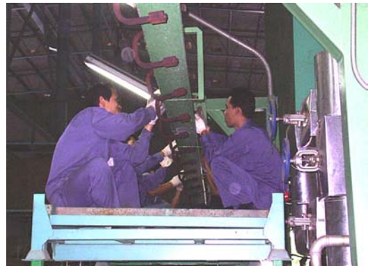
พนักงานกำลังขัดปีกทองเหลือง บน Shelf โดยแบ่งเป็น 2 ข้าง
