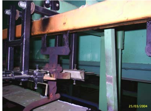
ลักษณะการเคลื่อนที่ของปีกทองเหลืองที่วิ่งผ่านชุดขัดแบบตะไบก่อนเข้าสู่ชุดขัดแบบกระดาษทราย
