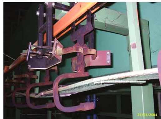
ลักษณะการเคลื่อนที่ของปีกทองเหลืองที่วิ่งผ่านชุดขัดแบบกระดาษทราย
