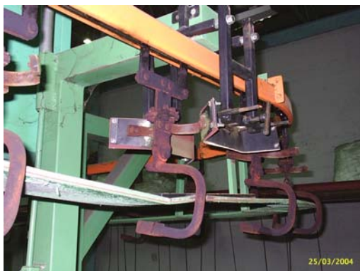
หลังจากติดตั้งชุดอุปกรณ์ขัดปีกทองเหลืองแบบกระดาษทราย
