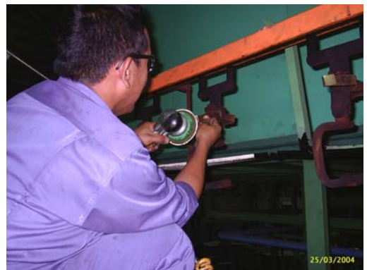
พนักงานกำลังขัดปีกทองเหลืองบน Shelf โดยใช้เครื่องขัด
